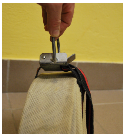
Pravilno zapet cevni nosilec
