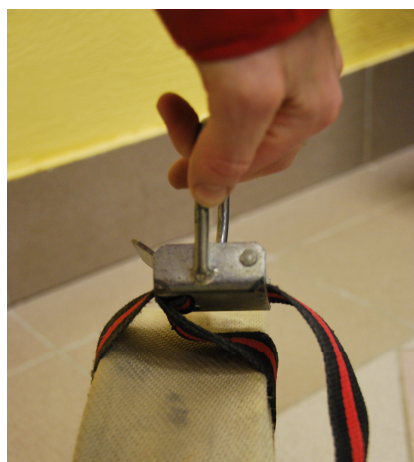
Nepravilno zapet cevni nosilec
